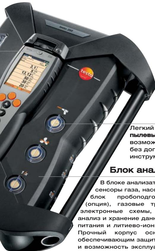
Легкий доступ к **пылевым фильтрам** и возможность замены без дополнительных инструментов.
